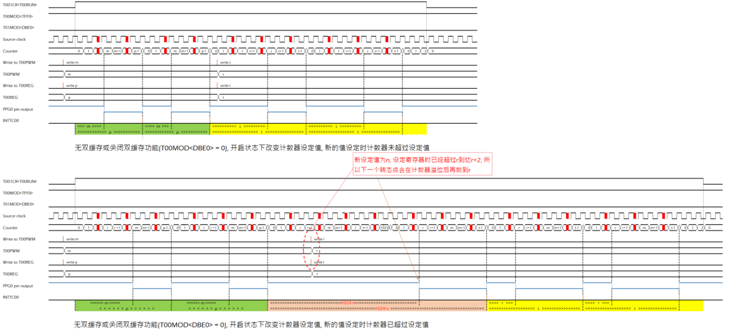
图 10.15 10 位可编程 PPG 模式时序图 (T00MOD<DBE0>="0")
